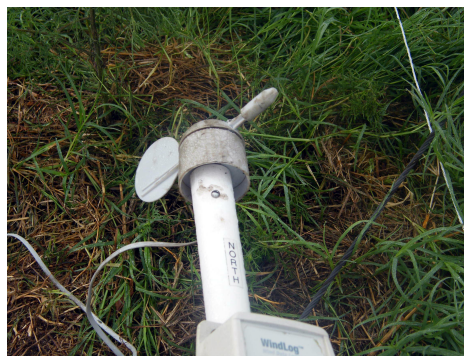
FIG. 21. Veleta de estación meteorológica Wh1081.
