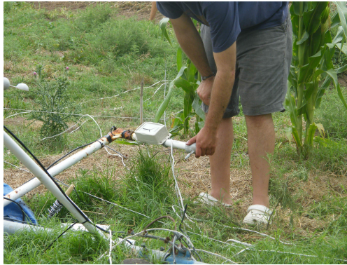
FIG. 36. Calibrando la veleta al norte geográfico
