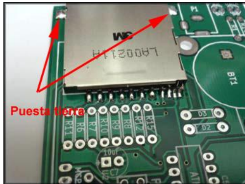
FIG. 68. Soldadura de la puesta tierra del porta tarjeta
