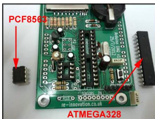
FIG. 80. Integrados utilizados: el PCF8563 y el ATMEGA328
