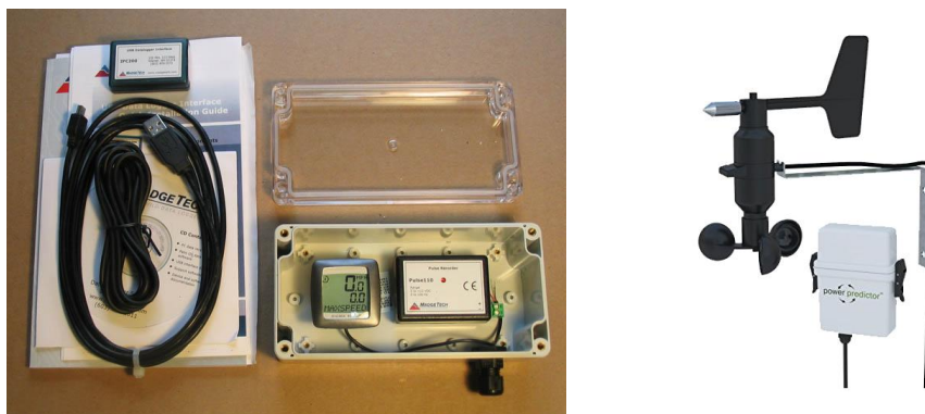
FIG. 41. Panel izq.: Registrador de datos Vortex . Panel der.: Registrador de datos Power Predictor Figuras tomadas de http://www.inspeed.com y http://www.reuk.co.uk/wordpress/wind/power-predictor-from-better-generation/ respectivamente.
