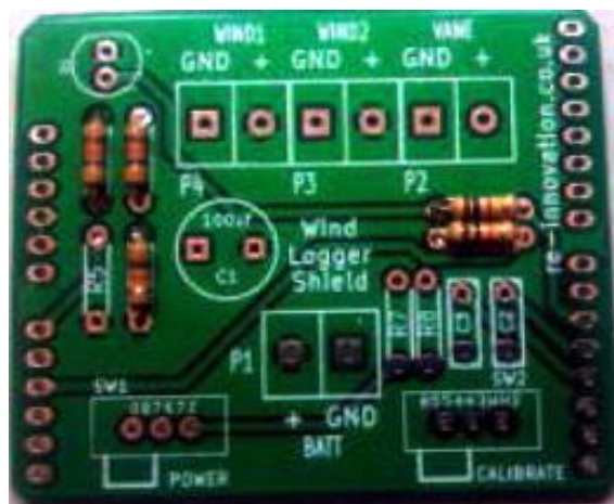
FIG. 83. Soldadura de las resistencias
