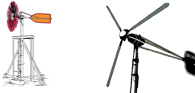
FIG. 5. Panel izquierdo: Molino multipala con bomba de pistón. Panel derecho: Generador de energía eólica Jacobs
