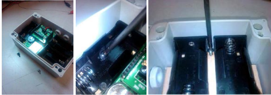
FIG. 56. Panel izquierdo: Caja eléctrica donde se monta el Data-Duino . Panel central: Ajustando el Data-Duino a la caja eléctrica con el tornillo de cabeza gruesa. Panel derecho: Ajustando el tornillo de cabeza delgada entre los dos porta pila
