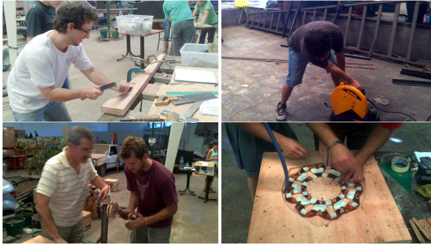
FIG. 10. Curso de 500 RPM proceso de fabricación del aerogenerador de 700W de diseño Piggott.
