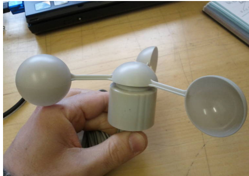
FIG. 20. Anemómetro de cazoletas N96FY utilizado en el proyecto.
