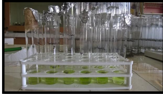
FOTOGRAFIA 13. Tubos de ensayo con resultados de determinación de clorofila contenida en las frondes de Salvinia minima .
