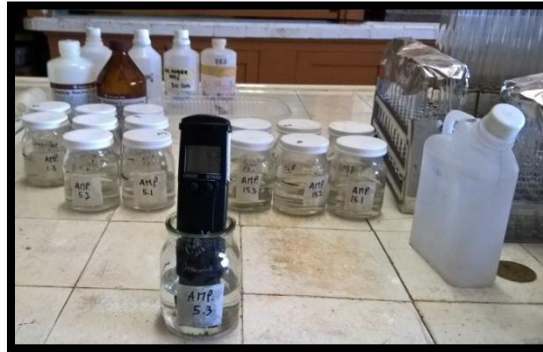
FOTOGRAFIA 9. Medición de conductividad y temperatura en muestras
