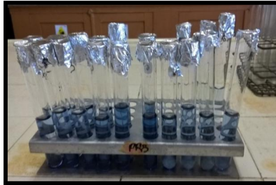
FOTOGRAFIA 11. Tubos de ensayo con resultados de determinación de Fósforo
