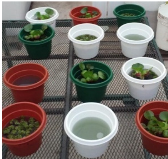
Figura 7. Fitorremediación con Eichhornia crassipes (camalote, tratamiento CA), Salvinia sp. (acordeón de agua, tratamiento SA), ambas (tratamiento AM) y control (tratamiento C).
