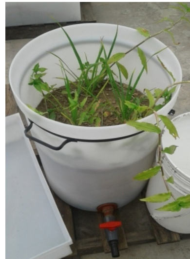
Figura 4. Esquema (izquierda) e imagen (derecha) del humedal construido a escala piloto.
