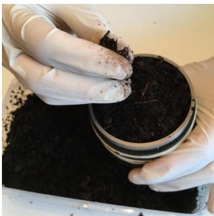
Fig.27: Llenado de conjunto de cilindros portamuestras. Fotografía del llenado de material N°2 – Turba Rubia de Musgo Sphagnum .
