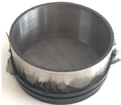
Fig. 22: Cilindro metálico de 4 cm de altura sobre la base de tela de voile ajustada por dos precintos.
