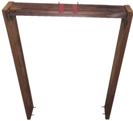
Fig.12 Dispositivo para tomar fotos con demarcación en color rojo para ubicar la cámara fotográfica. Fuente: Fotografía propia.
