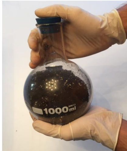
Fig.37: Contenedor mayor (balón de destilación) con tapa y lleno con materiales que forman el sustrato. Se procede a agitar manualmente. Fotografía de sustrato N° 1.
