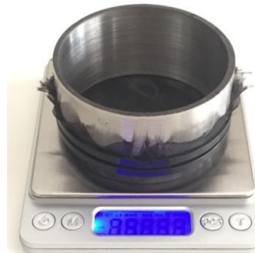
Fig. 23: Pesada del cilindro metálico portamuestras.
