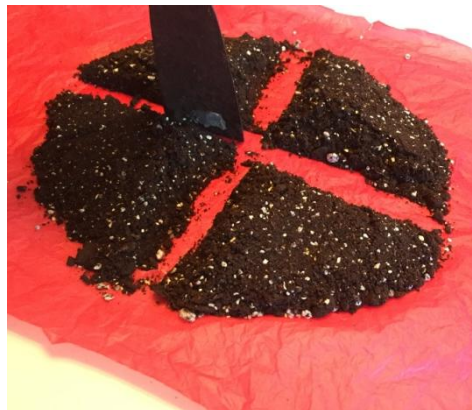
Fig.39: Separación del sustrato en cuatro cuartos aproximadamente iguales.
