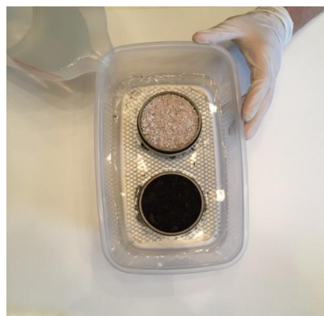
Fig.28: Colocación del conjunto de cilindros sobre rejilla en la batea y llenado de la misma. Fotografía del llenado de material N°2 – Turba Musgo Sphagnum y material N° 1 – Perlita Agrícola.
