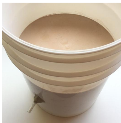
Fig. 21: Lecho de arena con drenaje instalado.
