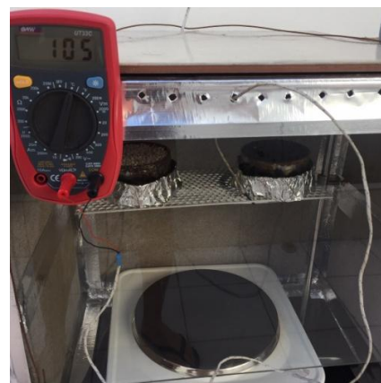
Fig. 32 (Izq.) y Fig. 33 (Der.): Muestras colocadas en sistema de secado, expuestas a temperatura mínima de 101°C (foto izq.) y máxima de 105°C (foto der). Fotografías de material N° 2 – Turba de musgo Sphagnum y material N° 1 Perlita agrícola.
