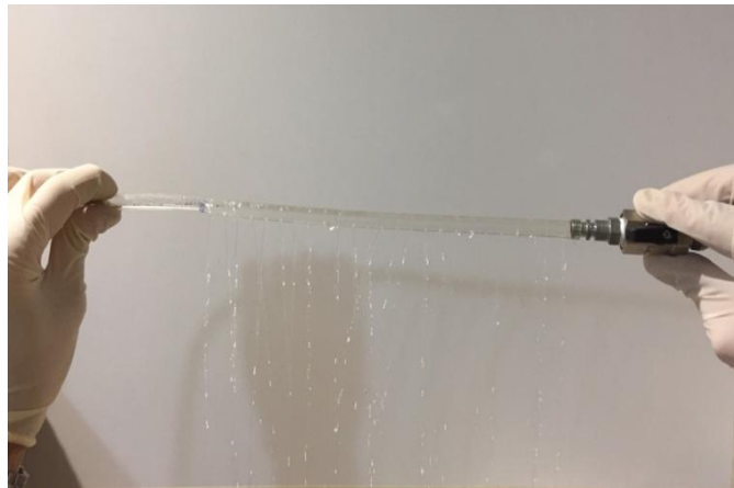
Fig. 17: Prueba hidráulica realizada a la manguera tubo perforada.
