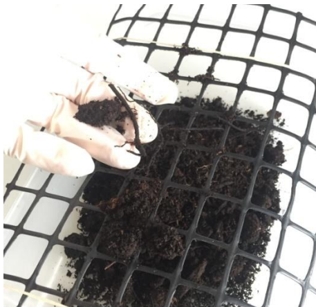
Fig. 25: Tamizado del material a muestrear. Fotografía del material N°2 – Turba Rubia de Musgo Sphagnum .
