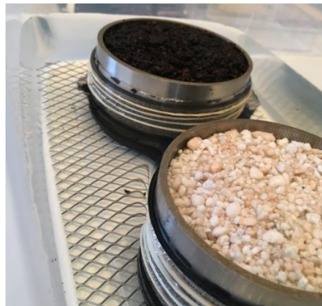
Fig. 29: Conjuntos portamuestras sumergidos en baño saturación. Fotografía de material N°2 – Turba Rubia de Musgo Sphagnum y materia N°1 – Perlita Agrícola.
