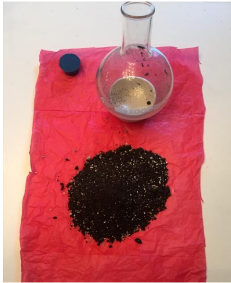
Fig.38: Sustrato N° 1 vertido sobre papel impermeable para homogenización y reducción equitativa.
