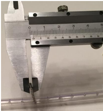
Fig. 16: Perforaciones de la manguera tubo demarcada, realizadas con mecha de \varnothing=2\text{mm} con 1 cm de separación.
