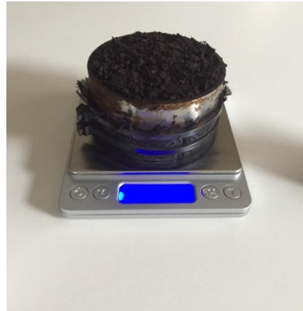
Fig. 31: Pesada de material saturado de agua. Fotografía de sustrato N°2 – Turba Rubia de Musgo Sphagnum .
