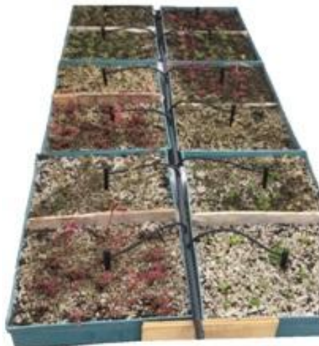
Fig.46: Bandejas con especies y sistema de riego. Fotografía tomada al momento de finalizar la plantación.
