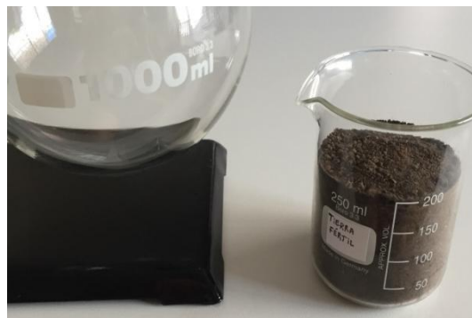
Fig. 34: Llenado de vaso de precipitado con material. Fotografía del material: Tierra Fértil.
