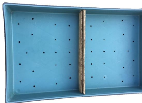
Fig. 40: Bandeja plástica con división realizada con tabla de madera.
