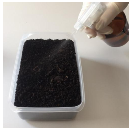
Fig. 26: Humectación del material. Fotografía de material N°2 – Turba Rubia de Musgo Sphagnum .
