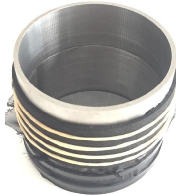
Fig. 24: Conjunto portamuestras metálico ya armado.
