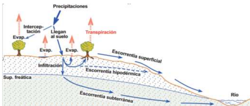
Figura 9. Componentes del ciclo hidrológico. Fuente: Imagen extraída de San Román, et al. (2012).
