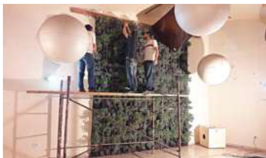
Figura 10. Montaje de los paneles para las mediciones.
