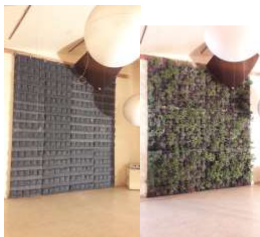
Figura 9. Colocación de la muestra en la cámara reverberante.
